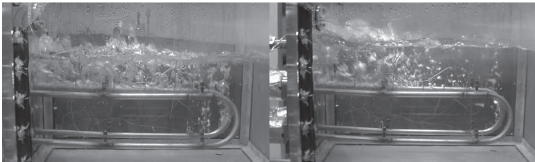
図 2 冷却水の沸騰(ヘリウム 0%)
