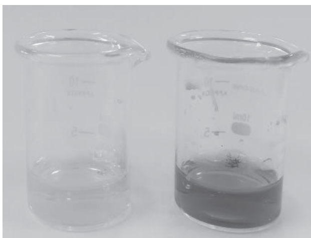
図 1 合成後 15 日目の水溶液状 PVA-KI へのヘリウムプラズマ照射の結果(左:室温保存、右:低温保存)
