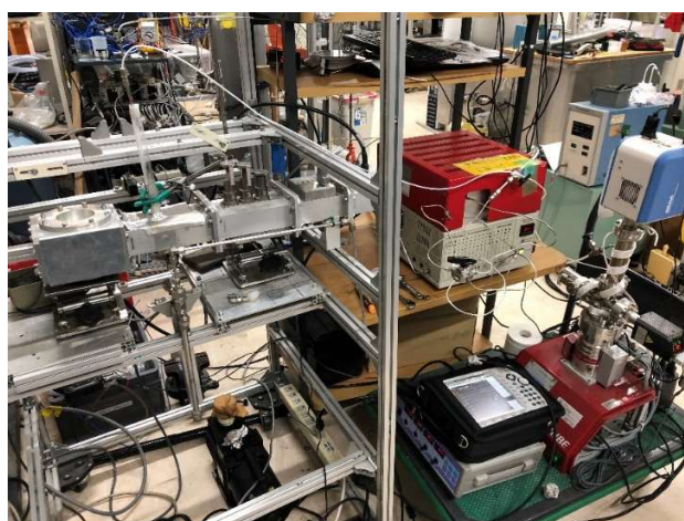
図1 マイクロ波加熱装置及びガス分析測定系の写真
