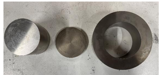
図 3 直径 100 mm の大型成型用金型
